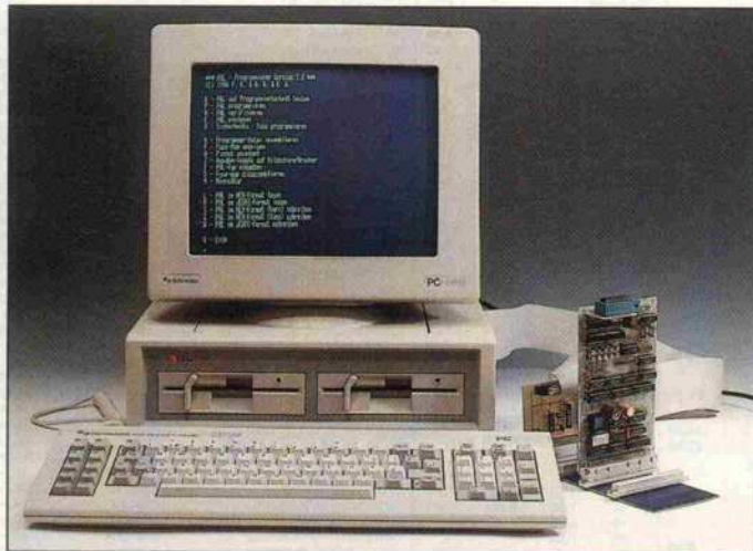
Kein Problem bereitet es dem Schneider PC, mittels ECB-Adapter den PAL-Brenner zu betreiben.
